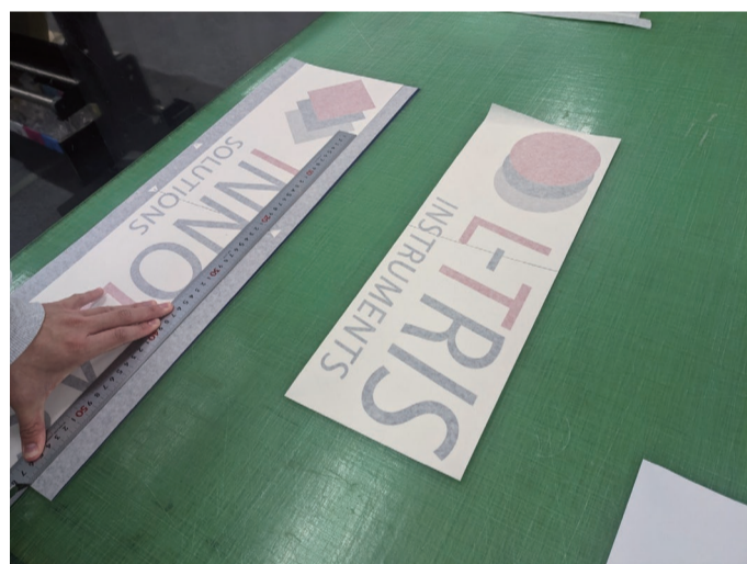
5. リタックシートを貼り、目安のセンターラインを書き入れて周囲をカットして完成。
